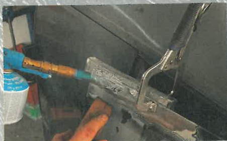
Zeichen von Handarbeit: Die obere Türkante ist ungleichmäßig – auch hier hilft Zinn
