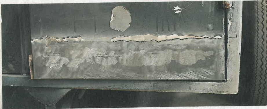
Fertig zur Weiterbehandlung: Etwas Spachtel ist fast immer noch nötig, doch wer sorgfältig arbeitet, kommt mit einer hauchdünnen Schicht aus. Vorm Spachteln noch mal mit Lösemittel über die gezinnten Stellen wischen
