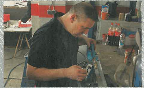
Das durchgerostete Türblech wird durch ein maßgefertigtes Teil ersetzt. Hier soll eine Überlappung entstehen, die Peer Gorgiel schon vorm Schweißen mit Lötpaste vorverzinnt. Dies geschieht nicht nur an der Tür selbst, sondern auch am Reparaturblech – Spenglerarbeit nach Altväter Sitte
