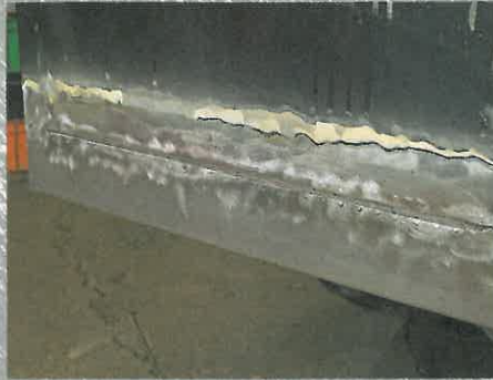
Nun wird das vorverzinnnte Neuteil angeschweißt, die Punkte anschließend verschliffen. Danach pinselet der Fachmann auch diese Nahtstelle noch mal mit Lötpaste ein, um den Schutz zu verbessern
