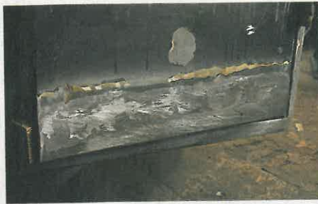
Schon ganz gut: Nach dem Hobeln kommt der Feinschliff. Am Übergang zum Lack zeigen...
