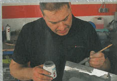
Wieder wird mit Lötpaste vorverzinkt, damit das Zinn von der Stange anschließend gut haftet
