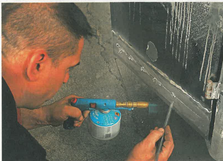
Erst nach dem Vorbehandeln kommt das Zinn von der Stange: Zunächst werden die Stücke verteilt, dann mit einem Hartholzspachtel verschwenmt – sprich: glattgestrichen. Dabei wird das Material mit der Lötlampe heiß gehalten. Vorsicht: Das weiche Zinn nicht in kalte Bereiche ziehen
