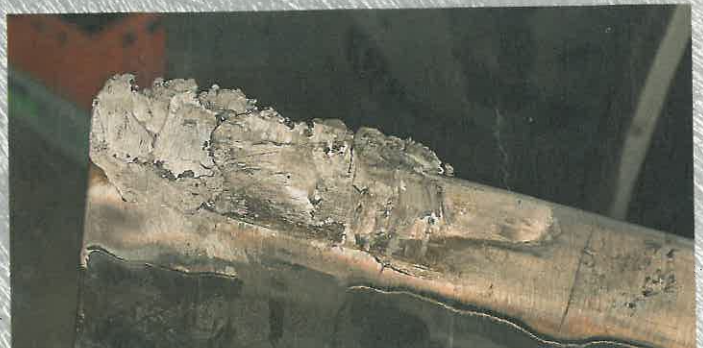
Wieder wird mit Lötpaste vorverzinkt, damit das Zinn von der Stange anschließend gut haftet
