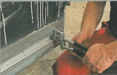
Das durchgerostete Türblech wird durch ein maßgefertigtes Teil ersetzt. Hier soll eine Überlappung entstehen, die Peer Gorgiel schon vorm Schweißen mit Lötpaste vorverzinnt. Dies geschieht nicht nur an der Tür selbst, sondern auch am Reparaturblech – Spenglerarbeit nach Altväter Sitte
